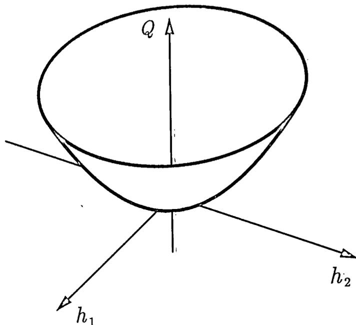
Figura 11.5: Gráfico da forma quadrática positiva definida  $Q(h_1, h_2) = h_1^2 + h_2^2$ .
