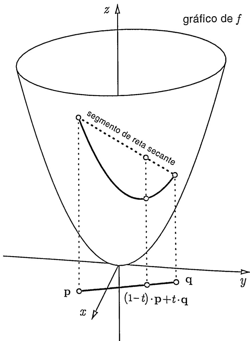
Figura 11.18: Para uma função convexa, o segmento de reta secante fica sempre acima ou coincide com o gráfico da função, para quaisquer escolhas de  $p$  e  $q$ .
