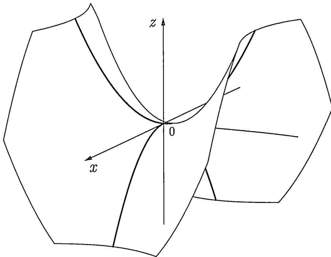
Figura 11.2: O ponto  $(0, 0)$  é um ponto crítico de  $z = f(x, y) = x^2 - y^2$  (a sela de cavalo) mas  $(0, 0)$  não é um extremo local de  $f$ .
