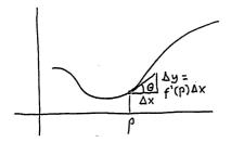
com o vértice esquerdo no ponto (p, f(p)), e com o cateto de baixo medindo  $\Delta x$  e o cateto da direita medindo  $\Delta y$ ... Às vezes isto é bem melhor que visualizar f'(p) como tan  $\theta$ .
